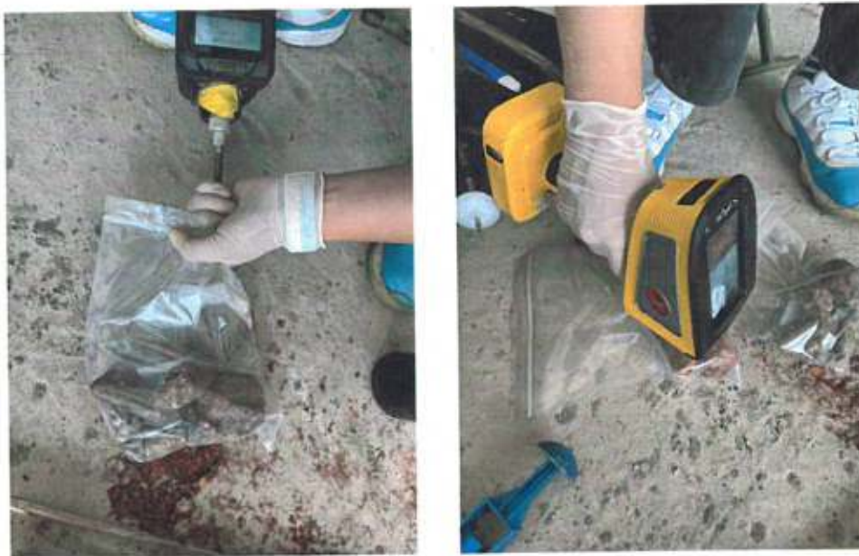
图 3 部分土壤现场快速检测图
